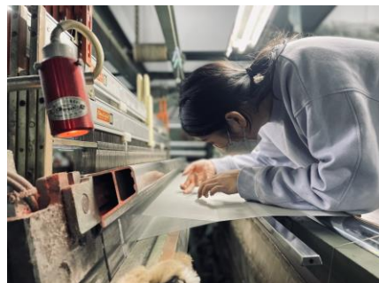
織っている最中も機械にセットされている糸を点検
